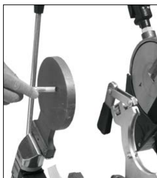
Kontrola teploty svařovacího zrcadla pyrometrem
