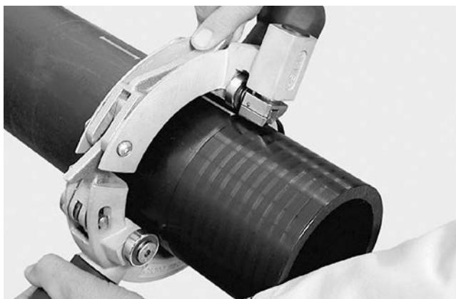
**Pozor! V případě materiálu PE 100 doporučujeme používat rotační škrabky!**
