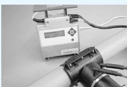
Nyní začněte svařovat pomocí vhodných svařovacích přístrojů. Použijte svařovací data pro svařování připojovaného kusu na sedlovou odbočku. Dbejte na správné nasazení připojovaného kusu do tvarovky SATURN.
