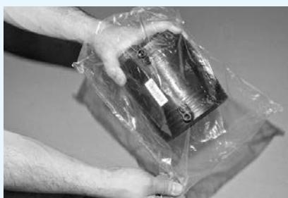
Vyjměte tvarovku z ochranného obalu, aniž byste se dotkli svařovací zóny. Pokud jste se dotkli nebo jinak znečistili vnitřní část tvarovky, očistěte ji.
