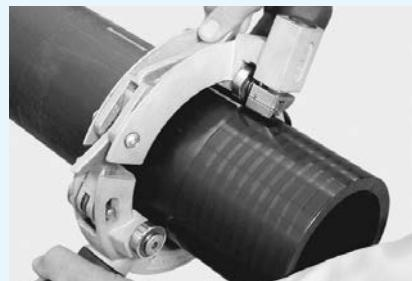
Očistěte připojovaný kus od hrubých nečistot a jeho hladký konec zbaťe zoxidované vrstvy rotační škrabkou. Délka oškrábání se musí rovnat nejméně hloubce vsunutí do odbočky. Dodržte minimální tloušťku oškrabání a maximální přípustné zmenšení tloušťky stěny. Postupujte podle montážního předpisu pro připojovaný kus.
