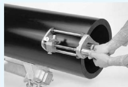
Nastavte škrabku na potřebnou délku. Jednou celou otáčkou škrabky (s čepelí v neutrální poloze) zkontrolujte ovalitu trubky. Bude-li potřeba, upravte ovalitu pomocí zakružovacích přípravků.
