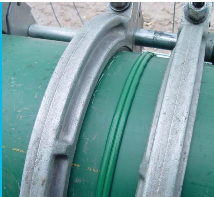
musí být čisté a bez úbytků teflonového povlaku, nepřípustné jsou jakékoli úniky hydraulického oleje, přerušení izolace elektrického vedení, atd.
