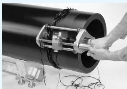
Odstaňte z trubky zoxidovanou vrstvu rotační škrabkou (při dodržení maximálního přípustného zmenšení průměru).
