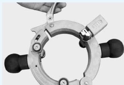
Z trubky odstraňte hrubé nečistoty. Poté odstraňte i zoxidovanou vrstvu pomocí rotační škrabky. Dodržte předepsanou minimální tloušťku odstraněné vrstvy a zároveň neprekročte maximální povolenou redukci tloušťky trubky.
