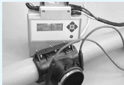
Nyní můžete svařovat pomocí vhodných svařovacích přístrojů. Použijte svařovací data pro svařování sedlové odbočky SATURN na hlavní řad.
