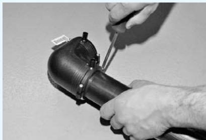
Pro elektrotvarovky do d63 mm pevně utáhněte uchycení pomocí šroubů.
