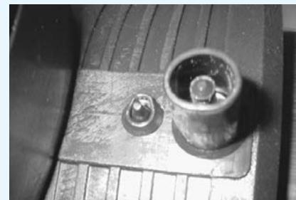
Po ukončení svařování zkонтrolujte indikátory svařování a údaje na displeji svařovací jednotky. Poté odpojte kabe-ly. Indikátory signalizují, že byla použita potřebná energie ke svařování, ale nezaručují kvalitu svaru, která závisí na více faktorech.
