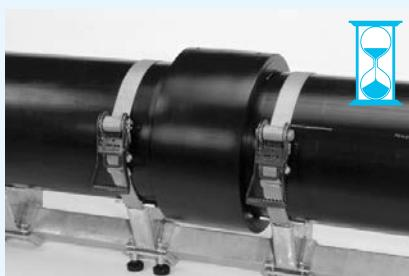
Po uplynutí doby chlazení odstraňteixační přípravky. Doba chlazení je uvedena na displeji a na etiketě s čárovým kódem.
