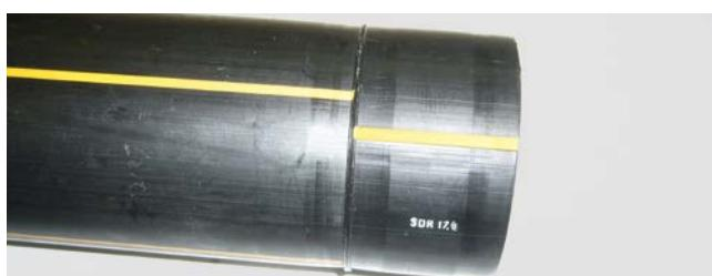
**Malý výronek** – malý výronek je známkou špatného svařovacího postupu například vynecháním fáze ohřevu nebo nízkou teplotou zrcadla během svařování.
