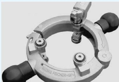
Očistěte připojovaný kus od hrubých nečistot a jeho hladký konec zavlečte zoxidované vrstvy rotační škrabkou. Délka oškrábání se musí rovnat nejméně hloubce vsunutí do odbočky. Dodržte minimální tloušťku oškrabání a maximální připustné zmenšení tloušťky stěny. Postupujte podle montážního předpisu pro připojovaný kus.
