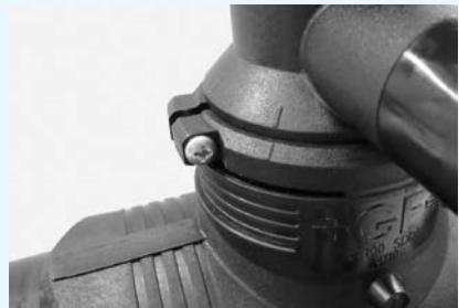
Po upnutí doby určené k ochlazení svarů odbočky a elektrospojky, provedte tlakovou zkoušku domovní přípojky.
