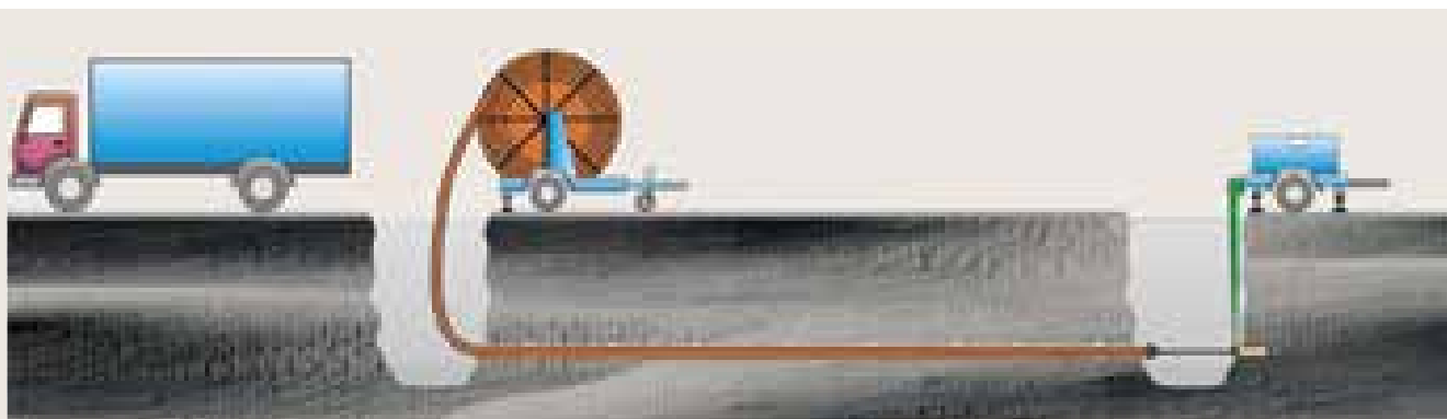
Zábor místa během instalace potrubí Compact Pipe
