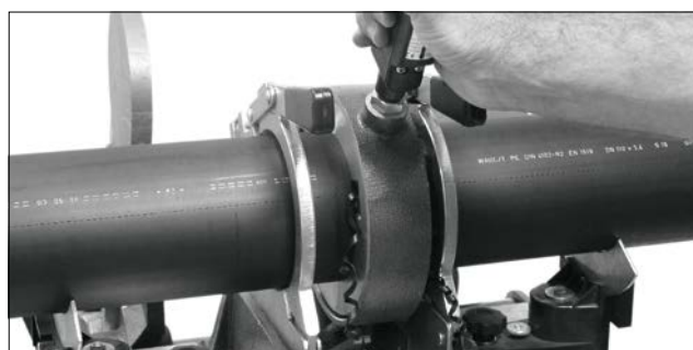
Srovnání konců potrubí integrovaným hoblíkem
