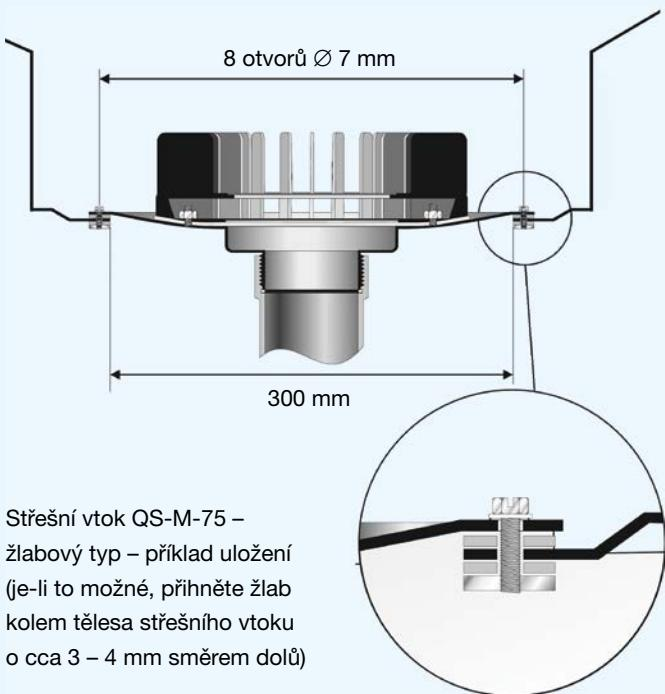
⑤ Střešní vtoky se umisťují dle projekčního výkresu vždy do nejnižšího bodu (úzlabí) uvažované odvodňované střešní plochy. Toto pravidlo platí i pro bezpečnostní vtoky – požadované vyvýšení přepadové hrany bezpečnostního vtoku oproti vtoku standardnímu je dosaženo již vlastní konstrukcí bezpečnostního vtoku.
