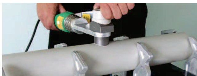
3/ Navařovací sedlo nasuneme na nástavec tak, aby na sebe navazovaly rysky na sedle a nástavci. Prohřejeme otvor i navařovací sedlo. Doba prohřívání je stejná jako u průměru 32 mm (8 s). V případě sedel 110 x 32 a 110 x 40 mm je doba prohřívání jako u průměru 40 mm (12 s).
