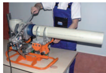
Upnutí do přípravku a vycentrování, poté nahřívání
