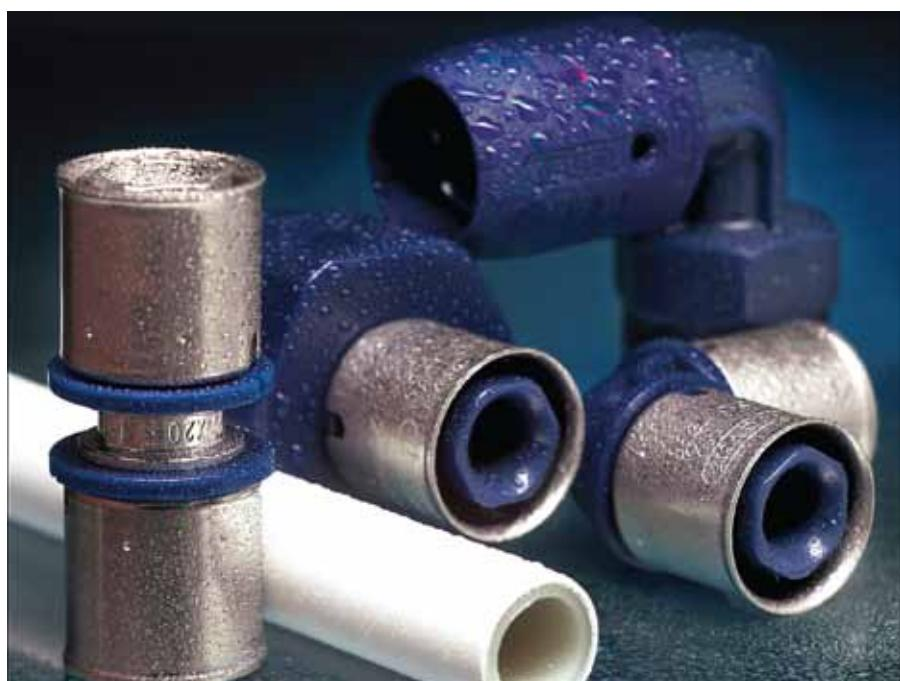
kontrolním otvorem, pomocí něhož lze před zalisováním bezpečně ověřit hloubku zasunutí trubky. Práci instalatéra pak ulehčuje nový šestihranný průřez tvarovky, který kladně ovlivňuje nasouvací síly a bezpečně odhalí nezalisovaný spoj. Patentovaný design tvarovky s šestihranným průřezem dále rozvíjí a kvalitativně posunuje systém Wavin M-press, využívající žádoucích vlastností pocínované mosazi.
