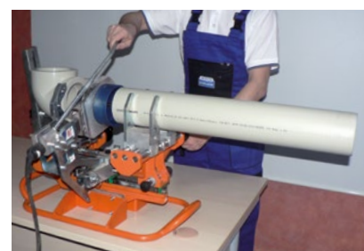
Upnutí do přípravku a vycentrování, poté nahřívání
