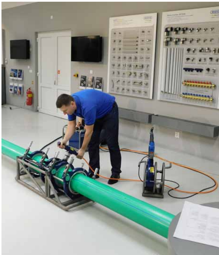
Ukázka svařování natupo (svařovací přípravek)
