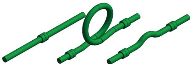
Provedení různých spojení systému PPR v rámci knihoven Wavin pro Revit
