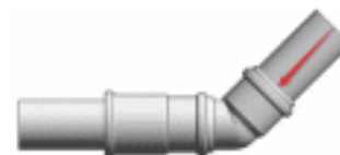
Správný směr proudění media odpadním potrubím
