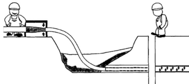
Jednotlivé trubky z PE jsou metodou „na tupo“ svařeny do tzv. svařenec požadované délky úseku sanace. Jednotlivé sanační úseky jsou svařeny pomocí elektrotvarovek. Po uvolnění napětí se potrubí vrátí do původního tvaru a dojde ke Close-Fit efektu.
