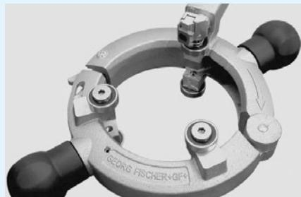
Očistěte připojovaný kus od hrubých nečistot a jeho hladký konec zbaťte zoxidované vrstvy rotační škrabkou. Délka oškrábání se musí rovnat nejméně hloubce vsunutí do odbočky. Dodržte minimální tloušťku oškrabání a maximální přípustné zmenšení tloušťky stěny. Postupujte podle montážního předpisu pro připojovaný kus.
