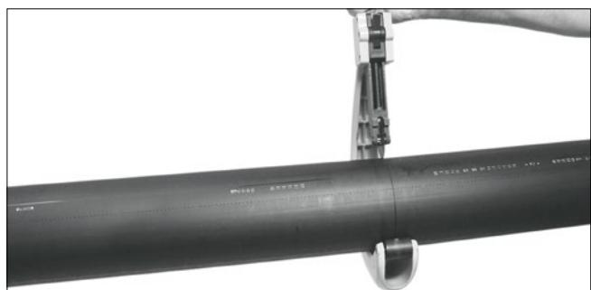
Řez potrubí ruční rotační řezačkou
