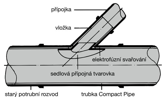
Vysazení kanalizační přípojky, bezvýkopově, pomocí robota
