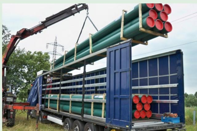
Tabulka platí pro potrubí rozměrové řady SDR 11 i SDR 17. Potrubí až do průměru d125 včetně lze dovézt v návinech na kamionu „megatruck“, kde platí standardní dohody o nákladech na dopravu. U návinů potrubí d140 a většího se používá kamion „special coil truck“ a je třeba počítat s dovozovými náklady na přepravu.
