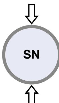
Pro pokládku do země se doporučuje, aby PE potrubí mělo minimální kruhovou tuhost  $S_{calc} > 4$  kN/m<sup>2</sup>. V opačném případě by se mělo provést statické posouzení. Statické posouzení by se mělo provádět také v případě zatížení dopravou, větší hloubky uložení, při riziku vyšší hladiny spodní vody, při výskytu složitých geologických podmínek a u pokládky bezvýkopovou technologií nebo u sanace s volným mezikružím.
