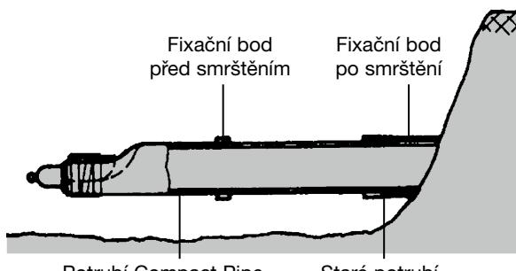
Příklad instalace fixačních bodů na potrubí Compact Pipe
