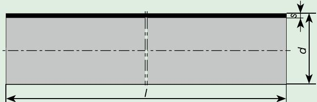
**Podklady PE 100 a PE 100 RC potrubí v 12m délkách SDR 17**
