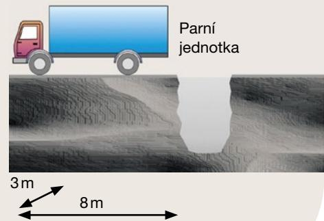
Fáze ochlazení končí, když je dosaženo teploty okolí. Během této doby se složené potrubí přetransformovalo na nové těsně přiléhající kruhové PE potrubí.
