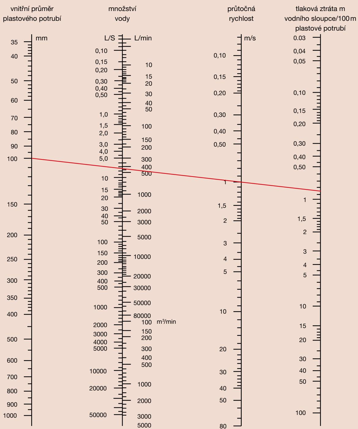
**Nomogram PE 100 a PE 100 RC potrubí SDR 17 pro rozvody vody s odečtem ztráty v %**
