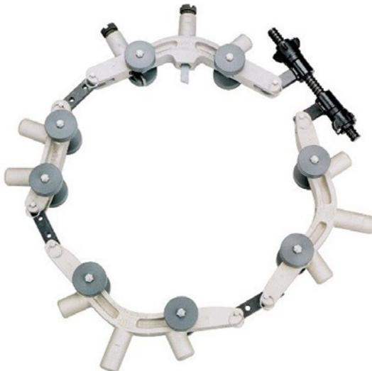
K řezání PE trubek je možné pro Rotační řezáky PLAS Rotary™ dokoupit břit PLASPEB č. 94485.
