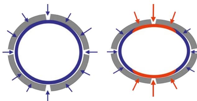
Vnější zatížení, které se přes stávající potrubí může zvětšovat
