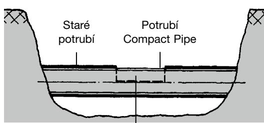
Příklady vyříznutí okna na starém potrubí pro instalaci odboček
