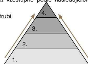
V následující části se budeme věnovat krokům 1. a 2., tedy tomu, jak stanovit stav stávajícího potrubí a jak nastavit požadavky pro nové potrubí. Krok 3. – výběr vhodných řešení, lze vyhodnotit z následujících kapitol tohoto katalogu a ke kroku č. 4 – výběr cenově nejpřijatelnějšího řešení, je nutné přistoupit až na základě cenových nabídek u vybraných řešení.
