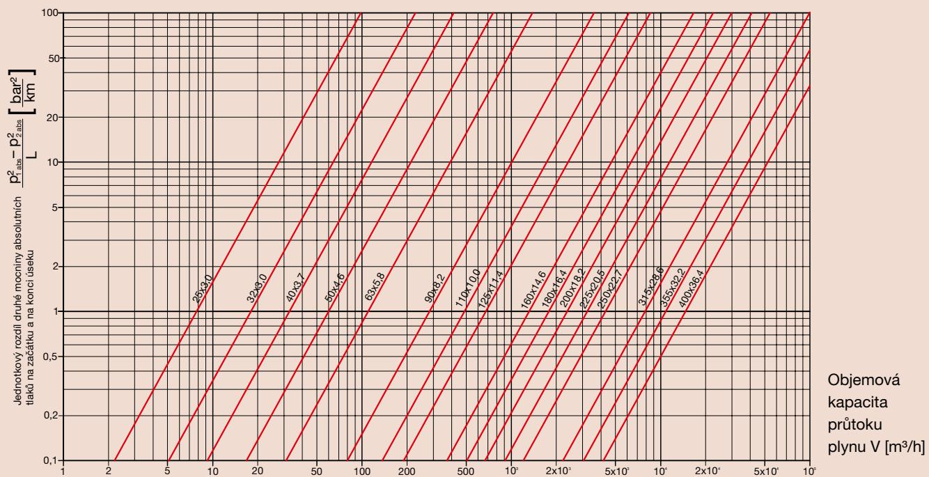
Nomogram PE 100 a PE 100 RC potrubí SDR 17 (SDR 17,6) pro střední a vyšší tlaky plynu
