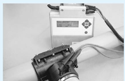
Nyní můžete svařovat pomocí vhodných svařovacích přístrojů. Použijte svařovací data pro svařování připojovaného kusu na sedlovou odbočku. Dbejte na správné nasazení připojovaného kusu do tvarovky SATURN. Po svařování zkонтrolujte indikátory na displeji svařovací jednotky.
