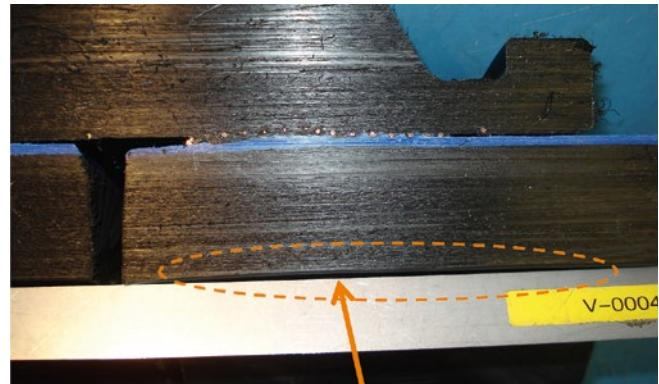
Zejména u velkých průměrů PE potrubí se stále častěji setkáváme s podceněním efektu, který se nazývá padlý konec PE potrubí. Pokud svářec tento padlý konec neodstraní v dostatečné délce, hrozí obnažení odporového drátu a únik taveniny dovnitř potrubí.
