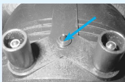
Po ukončení svařování zkontrolujte indikátory svařování a údaje na displeji svařovací jednotky. Poté odpojte kabely. Indikátory signalizují, že byla použita potřebná energie ke svařování, ale nezaručují kvalitu svaru, která závisí na více faktorech.
