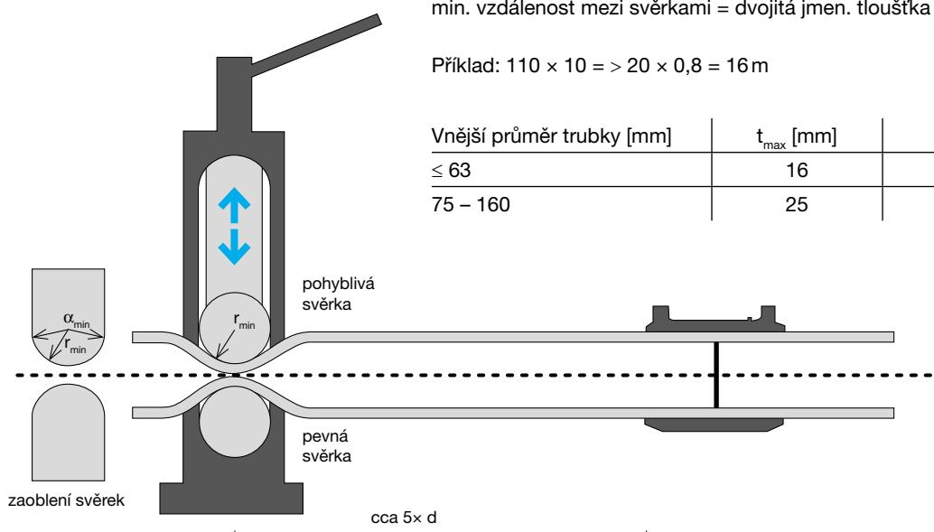
Úlohou zaokrouhlovacích svěrek je vytvarovat stlačenou trubku znovu do kruhového tvaru. Poloskořepiny zůstávají na trubce tak dlouho, dokud není vytvarována. Mohou být rovněž spojeny a mohou na trubce zůstat trvale.
