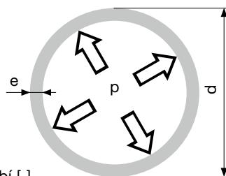
SDR rozměrová řada potrubí [-],
