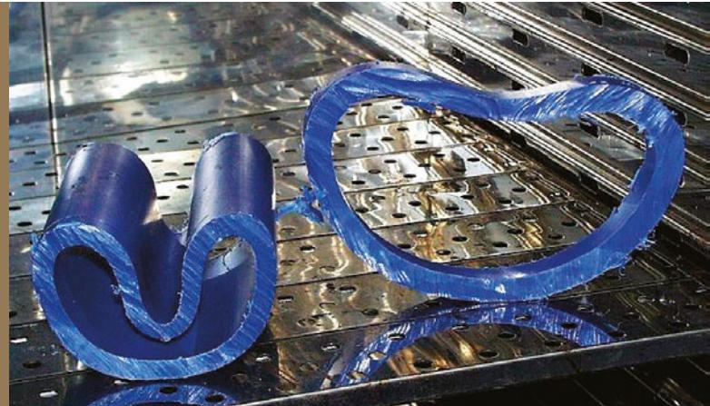
Technologii provozuje celosvětová síť cca 40 licencovaných instalačních firem. Tyto firmy byly všechny vyškoleny firmou Wavin a jsou kvalifikovány předeformovat vyrobené potrubí ve složeném stavu na nové potrubí nainstalované uvnitř starého.
