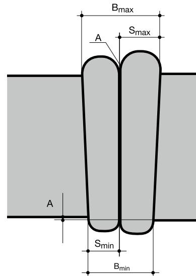
Tavenina musí mít po celém obvodu tvar vzájemně se dotýkajících válečků. Maximální a minimální šířka taveniny ( $B_{min}$  a  $B_{max}$ ) se musí nacházet v rozmezí uvedeném v tabulkách parametrů svařování podle druhu spojovaných prvků (jmenovitý průměr, třída PE, SDR). Navíc, maximální šířka výronku  $B_{max}$  a minimální šířka výronku  $B_{min}$  se nesmí lišit o více jak 20 % od hodnoty průměrné šířky taveniny  $B_M$ , počítané jako aritmetický průměr maximální a minimální hodnoty.
