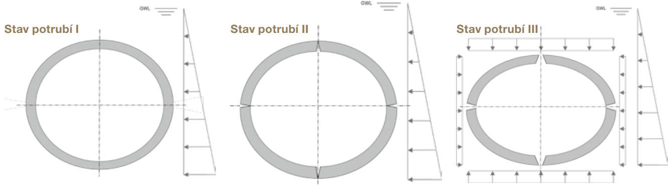
V případě zátěže pouze spodní vody je třeba vzít v úvahu vnější tlak, i když je vložka uzavřena starou trubkou. Je zřejmé, že tento vnější tlak roste s rostoucí výškou spodní vody nad potrubím. V případě přílišné zátěže se může vložka nakonec staticky zbourat.
