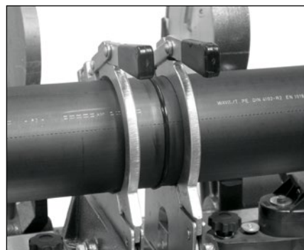
Chladnutí svařeného spoje
