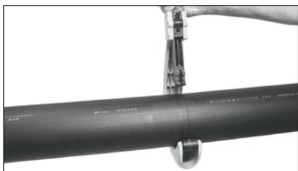
Řez potrubí ruční rotační rezačkou
