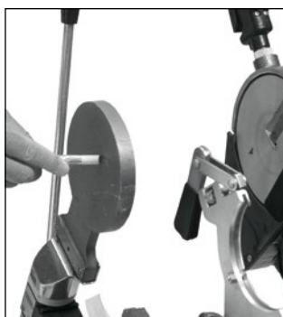
Kontrola teploty svařovacího zrcadla pyrometrem
