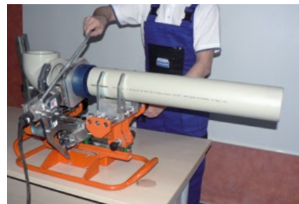
Upnutí do přípravku a vycentrování, poté nahřívání
