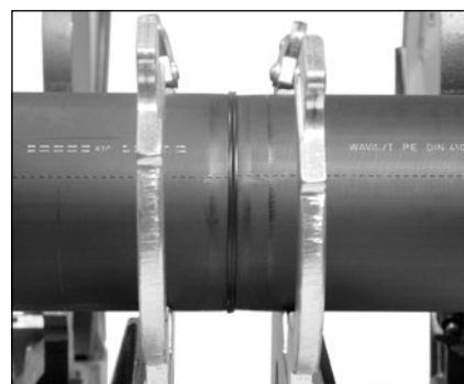
Správně vytvořený svarový spoj na tupo
