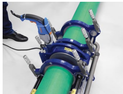
Srovnání konců potrubí hoblíkem
