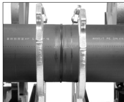
Správně vytvořený svařový spoj natupo
